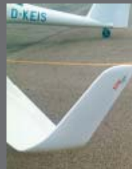
Die Winglets verhelfen dem Carat A zu guten Langsamflug-Leistungen und -Eigenschaften.
