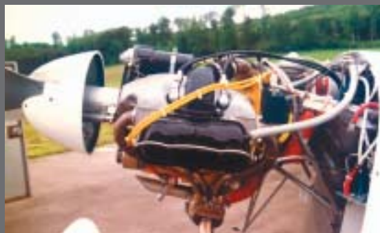
Mit abgenommener Cowling liegt der Sauer-Motor gut zugänglich vor einem.
