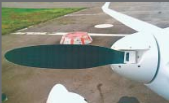
Der vorgefaltete Schnabel-Propeller erzeugt kaum Zusatzwiderstand.
