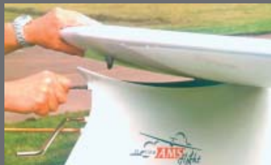
Die Höhenleitwerksmontage ist „Original-Discus“-Standard nach dem Hänle-Prinzip.
