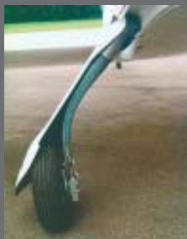
Die Fahrwerksbeine sind sehr robust und brauchbar gefedert, bieten allerdings wenig Dämpfung.
